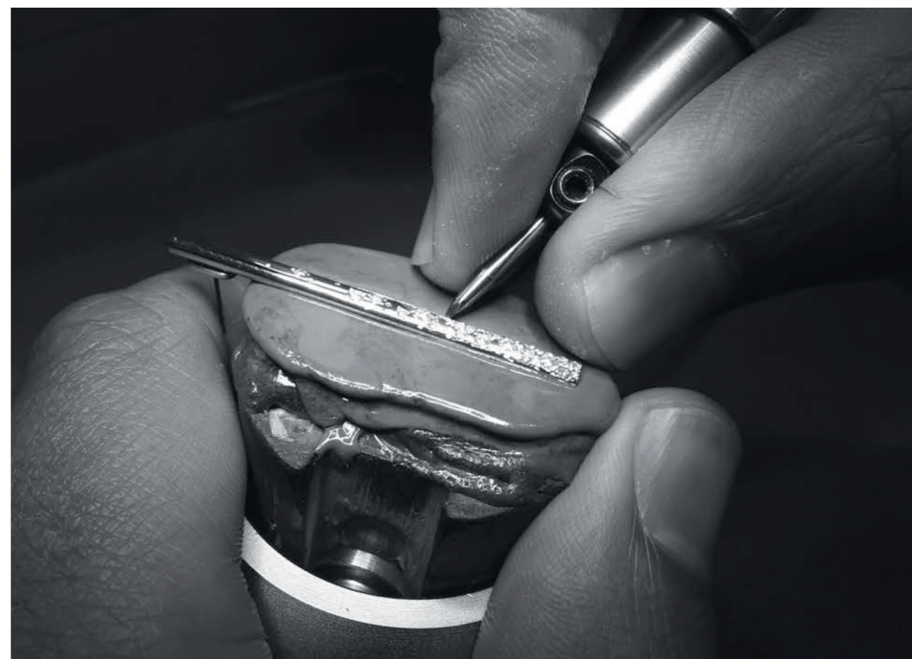
So entstehen kleine Wunder: Der Rotgoldstab wird abgelängt, vorgepoliert und mit Diamanten besetzt.
