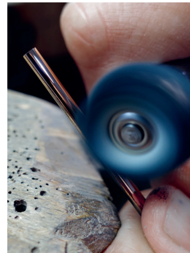
So entstehen kleine Wunder: Der Rotgoldstab wird abgelängt, vorgepoliert und mit Diamanten besetzt.
