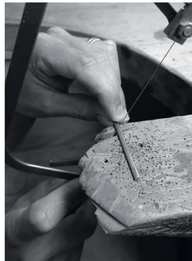
So entstehen kleine Wunder: Der Rotgoldstab wird abgelängt, vorgepoliert und mit Diamanten besetzt.
