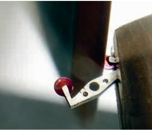
Keine zwei Millimeter lang: Rubinpalette beim Polieren.
